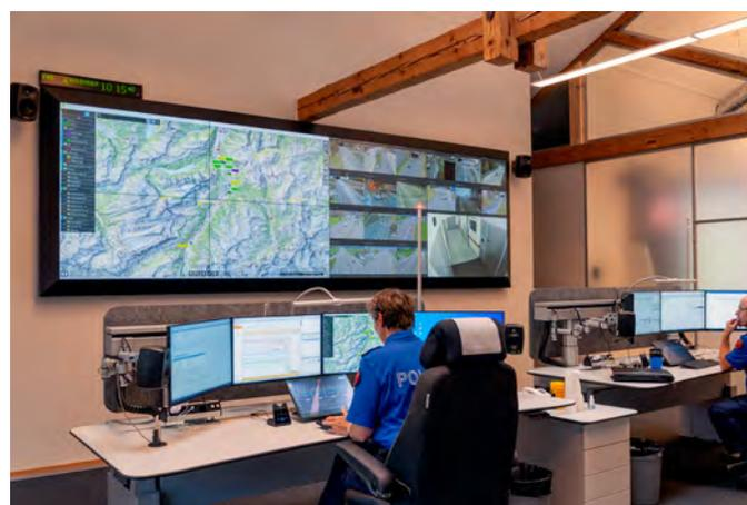
Für dieses Projekt installierte die AVS Systeme AG die maßgeschneiderte VuScope-Videowandsteuerung mit TRx, der fortschrittlichen Videowand-Management-Software von VuWall. VuScope ist ideal für Kontrollräume, Kollaborationsräume und Corporate Signage. Es ermöglicht Unternehmen die einfache Steuerung und Verteilung nahezu jeder Quelle an jedes Display im Netzwerk mit einem Höchstmaß an Flexibilität und einer voll ausgestatteten Verwaltungssoftware.
